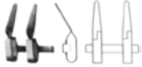
BIEMER-MÜLLER BT-1170 Çene uzunluğu/Length of jaws.9 mm Açıklık/Opening 5 mm Kapanma kuvveti/Closing force 25-30 gr.
